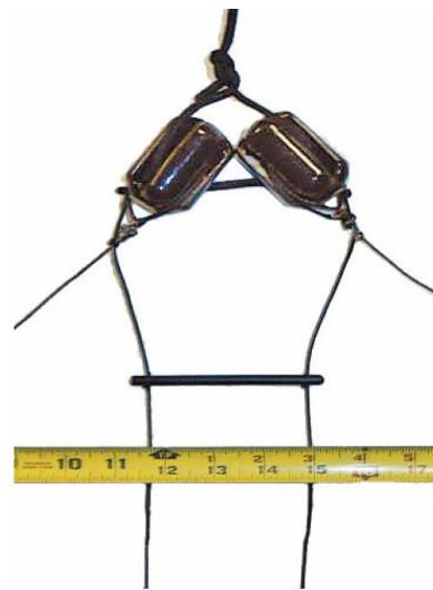
Rys. 2.7.3. Sposób podłączenia linii drabinkowej
