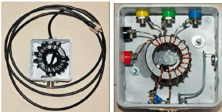
Fot. 5.5.9. Dławik z 3-metrowym odcinkiem kabla
