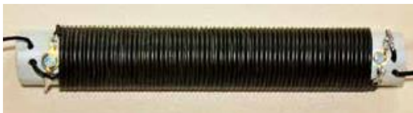
Fot. 5.5.7. 69-zwojowa cewka jest nawinięta na 25-milimetrowej rurce z PCW
