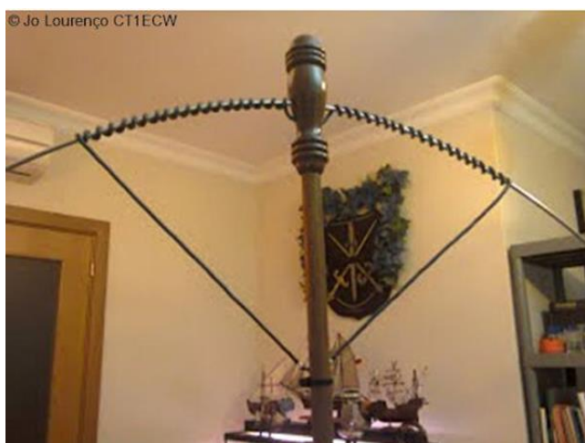
Rys. 1.1.12. Sprzężenie za pomocą uzwojenia nawiniętego na pętli anteny na zakres 7 – 21 MHz. Tworzy ono swego rodzaju transformator delta
