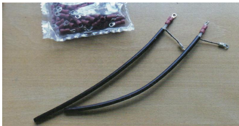
Fot. 1.3.2. Wykonanie kondensatorów koncentrycznych
