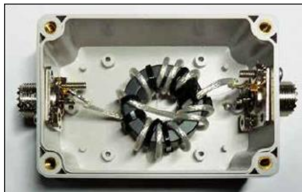
Fot. 6.8.3. Dławik wykonany z kabla RG316
